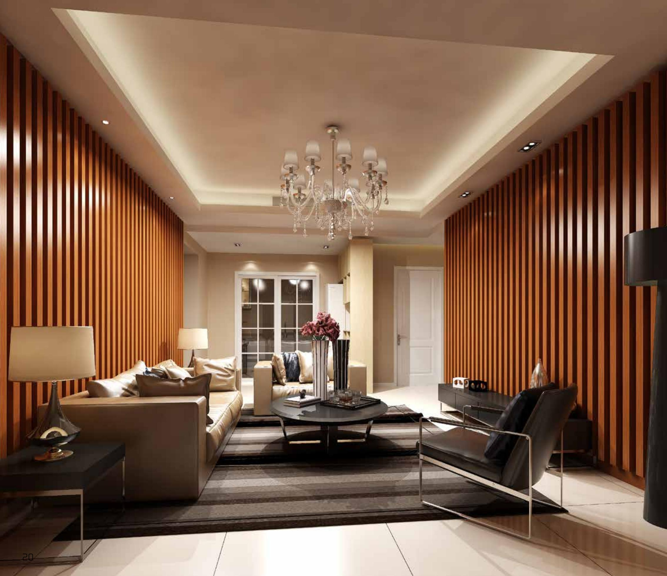
Die Paneel Höhe beträgt 2400 mm, darunter 100 mm Sockelleiste, somit ist es für eine Gesamthöhe von 2500 mm konzipiert. Die Sockelleisten mit 100 mm oder 250 mm können bei Bedarf schmaler gemacht werden und gewährleisten durch Montage an oberer und unterer Seite auch eine Anbringung an unterschiedlichen Wandgrößen. Da die nebeneinander angebrachten Paneele sich überlappend montiert werden, sind keine Nahtstellen zu sehen.
